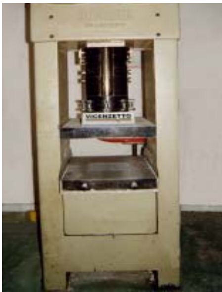
PROVE SU ROCCIA - Pressa per prove di compressione
