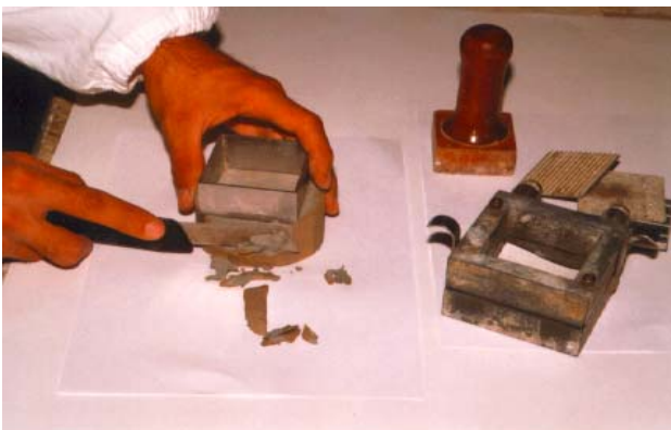
Preparazione del provino per prova di taglio diretto
