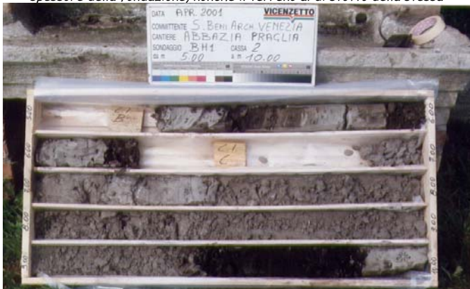
Cassette porta carote nelle quali è facilmente individuabile il materiale e lo spessore della fondazione, nonché il terreno al di sotto della stessa
