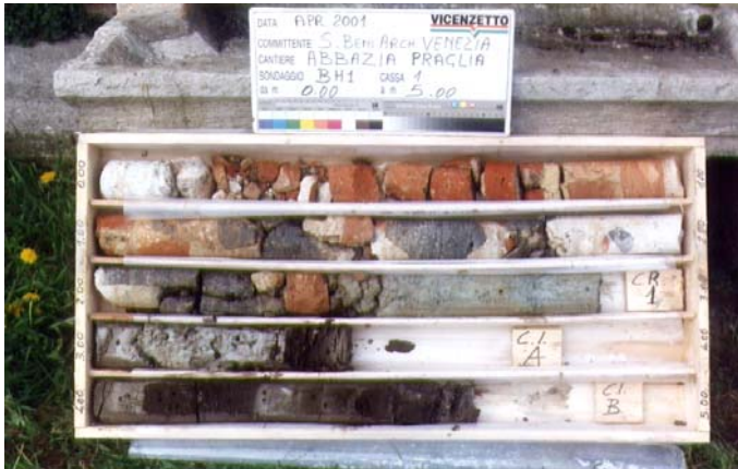
Cassette porta carote nelle quali è facilmente individuabile il materiale e lo spessore della fondazione, nonché il terreno al di sotto della stessa
